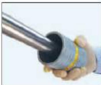
Quitar la rebaba para evitar dañar la junta.
