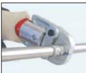
Efectuar el prensado
